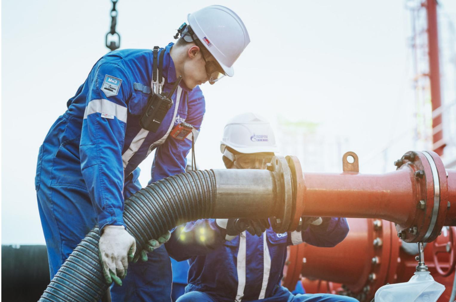
Отгрузка нефти с танкера «Штурман Кошелёв» на плавучее нефтехранилище (ПНХ) «Умба» на рейде в Кольском заливе.
