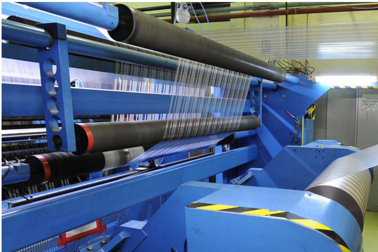
*Производство компании «Конфлекс». Одна из высокоскоростных бобинорезок.*
